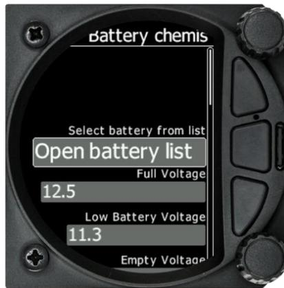
En sélectionnant une batterie dans la liste, les paramètres préétablis pour Full Voltage, Low Battery et Empty Voltage sont affichés.
