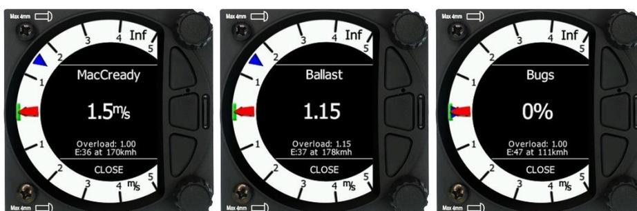
Pour changer la valeur du MacCready, appuyez sur le bouton rotatif du bas et sélectionnez MC/BAL. Un appui court du même bouton vous fait passer de MC à Ballast et en appuyant une nouvelle fois vous accédez au Bugs. Si aucune action n'est réalisée dans les 3 secondes, la boîte de dialogue disparaît. L'utilisateur peut également sortir en appuyant sur le bouton poussoir du bas (CLOSE).
