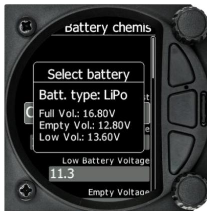
Vous pouvez manipuler ces paramètres manuellement si votre batterie n'est pas listée par exemple. Ces paramètres influencent la représentation du niveau de batterie et l'alarme de batterie faible.
