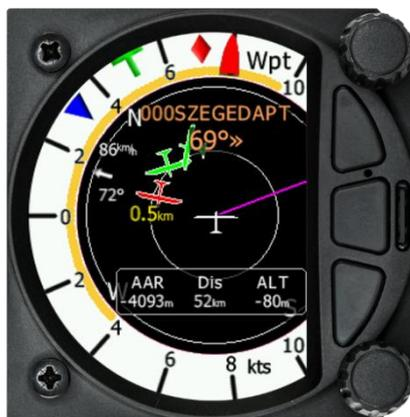
La première page montre la ligne reliant le planeur au point de virage, le nom du point sélectionné en haut de l'écran et le cap relatif avec les chevrons indiquant la direction du point.
