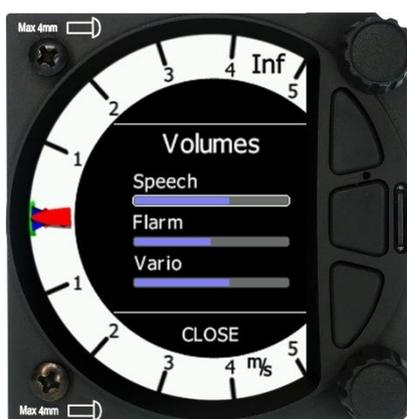
Le bouton rotatif du bas sert à ajuster les paramètres dans le mode actuel ou dans les menus. Avec celui-ci, l'utilisateur peut accéder au calage Mac Cready, aux ballasts et au bugs setting (pourcentage de dégradation de la polaire).
