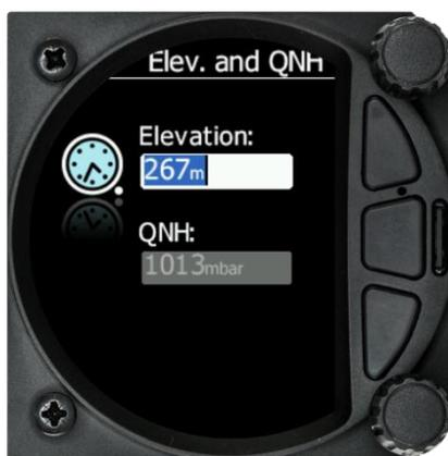
Il est possible de régler l'élévation par rapport au niveau standard de pression (1013,25hPA). Utilisez la molette pour régler cette valeur.
