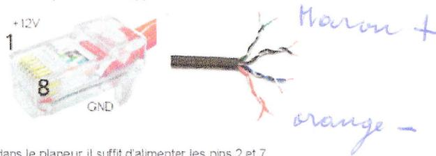
Pour l'utilisation normale dans le planeur il suffit d'alimenter les pins 2 et 7
